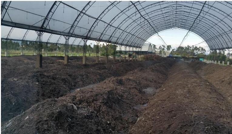
La materia orgánica seleccionada se dispone en hileras al aire libre, para oxigenar las pilas, se voltean de forma manual o mecánica las hileras periódicamente. Para acelerar el proceso, se puede realizar una oxigenación con aire forzado (aire se distribuye dentro de las pilas mediante tuberías perforadas y un inyector de aire).
