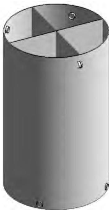
Figura 62: Esquema Tanque de contacto.
