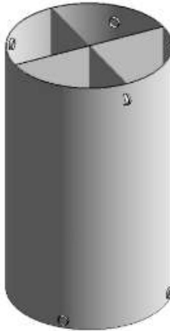
Figura 59: Esquema Tanque de contacto.
