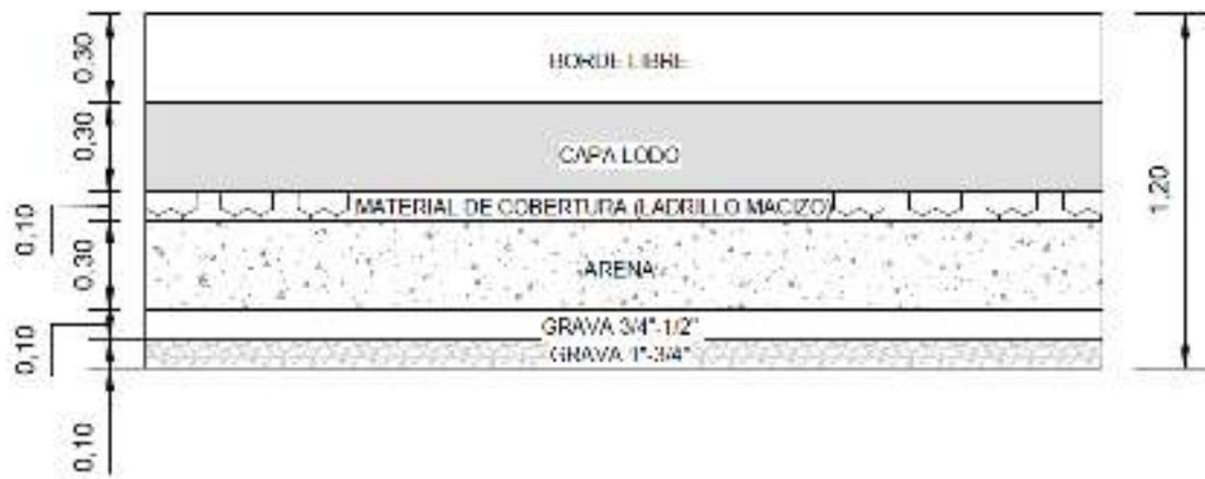
Figura 63: Estratificación de la estructura del lecho de secado (medidas en metros).
