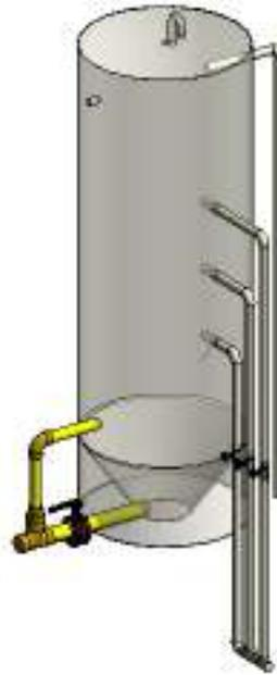
Figura 61: Esquema del espesador hidráulico.
