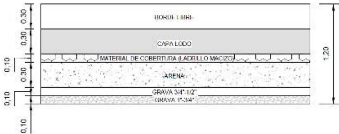
Figura 72: Estratificación de la estructura del lecho de secado (medidas en metros).
