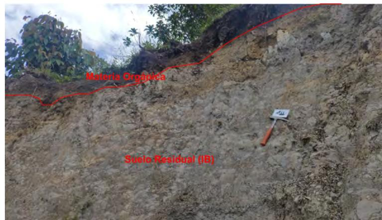
Figura 92: Suelo Residual (IB) de Formación Seca (KPgs)
