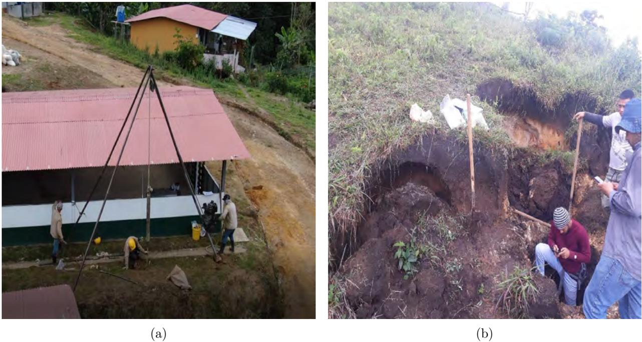
Figura 169: Ilustraciones de apiques y perforaciones. (a) Perforaciones a 6m y 3m de profundidad con diámetro de 55mm con toma de muestra alterada o inalterada cada 50cm. (b) Apique con dimensiones 1x1x1,5m con toma de muestra inalterada a 0,5m de profundidad y alterada a 1,5m.
