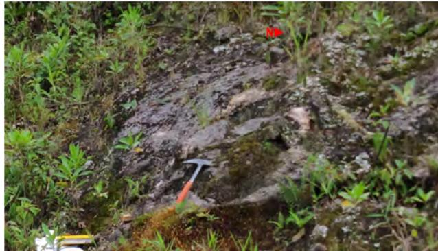
Figura 90: Roca Alterada IIB (Parcialmente Meteorizada)
