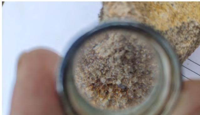
Figura 91: Roca Alterada IIB (Parcialmente Meteorizada)
