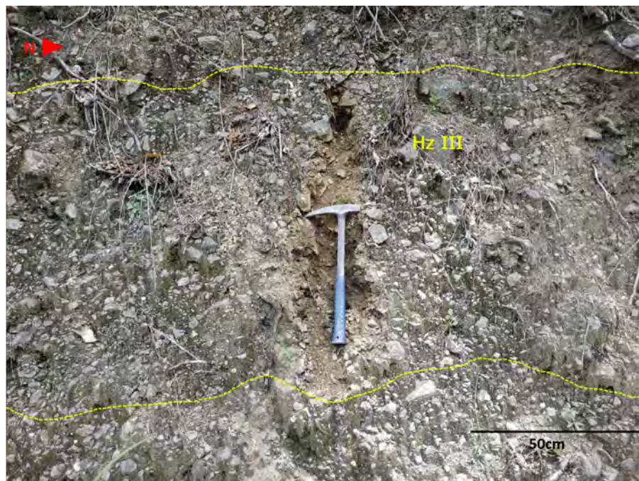
Figura 89: Perfil de meteorización unidad de basaltos y diabasas: Horizonte III
