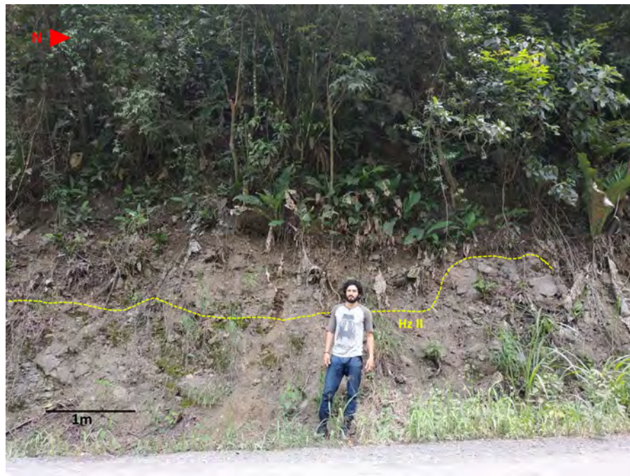
Figura 88: Perfil de meteorización unidad de basaltos y diabasas: Horizonte II
