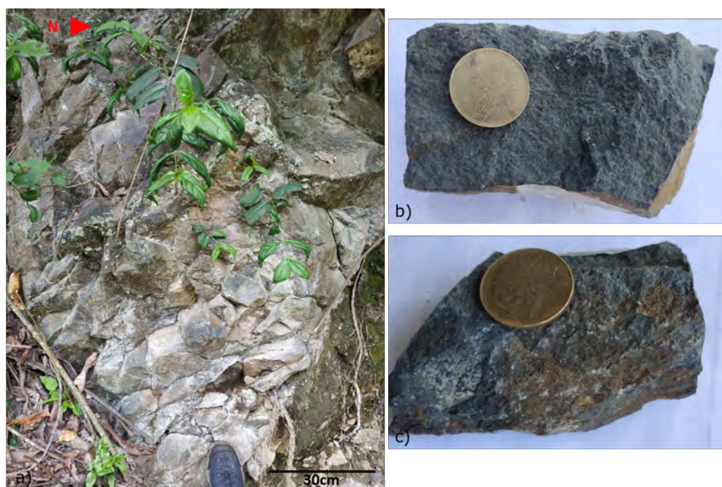
Figura 87: Unidad de diabasas. a) Afloramiento de roca fresca a alterada con algunas fisuras (horizonte I). b) Diabasa en muestra de mano. c) Pátinas de óxido en muestra de diabasa
