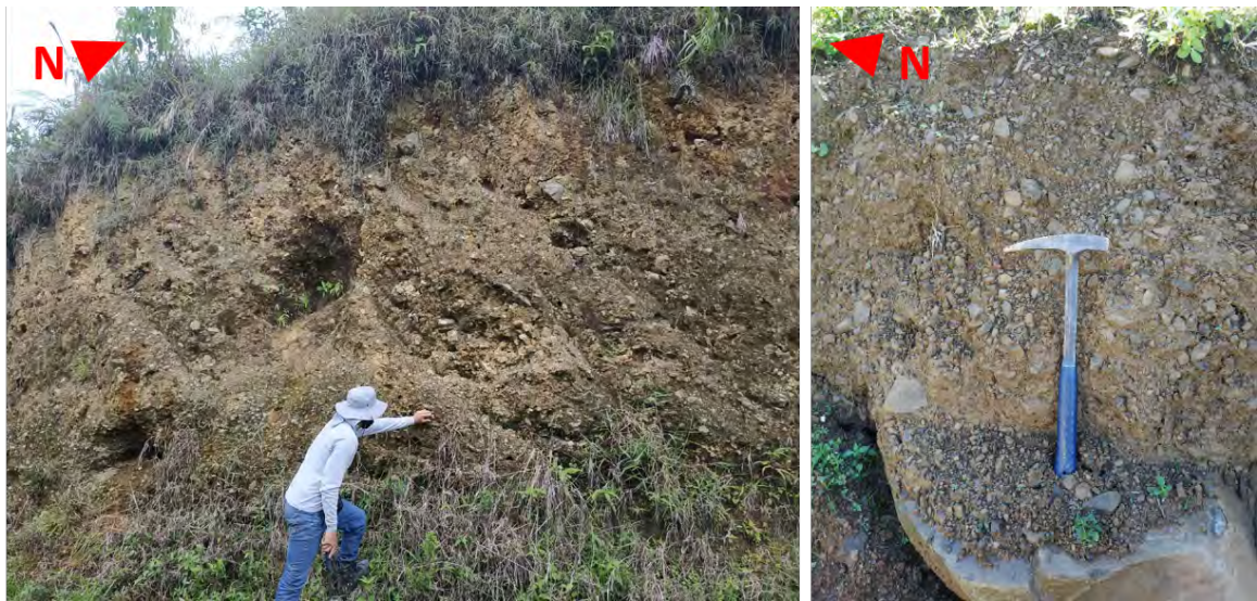
Figura 101: Perfil del material que conforma el depósito de vertiente
