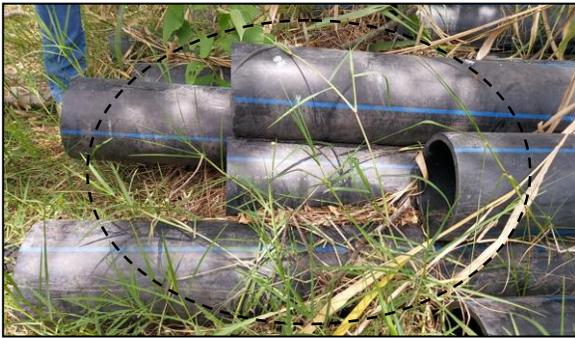
Imagen 5. Tubería de polietileno de alta densidad, categoría de alto rendimiento, soporta de manera segura presión nominal de 10 bares (145 PSI), cumple norma técnica RDE 17, ubicada al costado en el camino Herradura – Palmira, corregimiento La Herradura.
