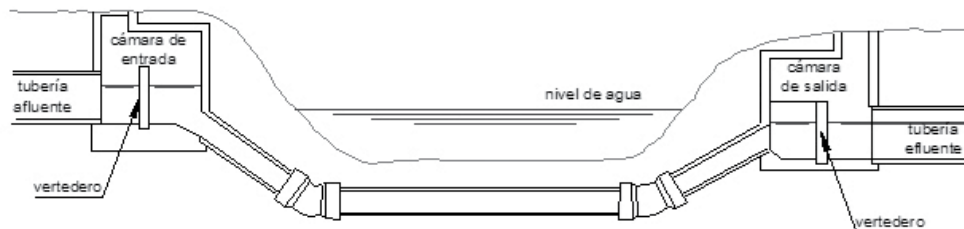
Figura D.7.28 Esquema sifón invertido
