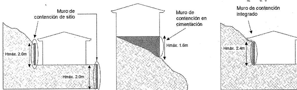
Figura 6-1 Tipologías de muro de contención
