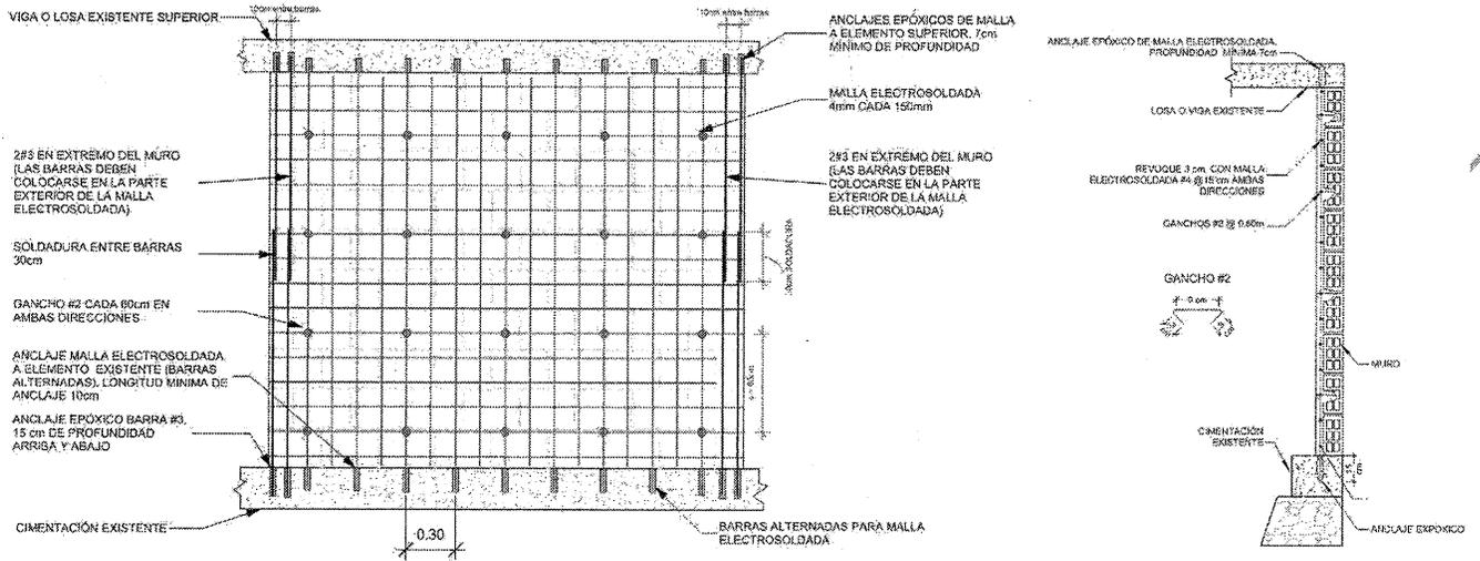
Figura A.3 -17 Conexión de muro nuevo a losa maciza existente.
