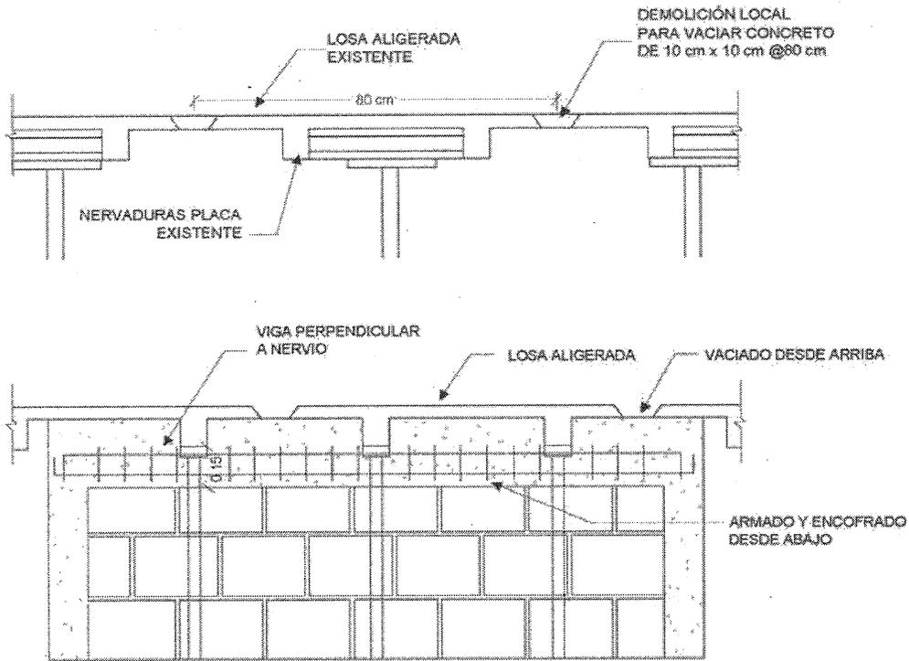
Figura A.3 -19 Conexión de muro nuevo a losa existente con nervios. Muro paralelo a los nervios.
