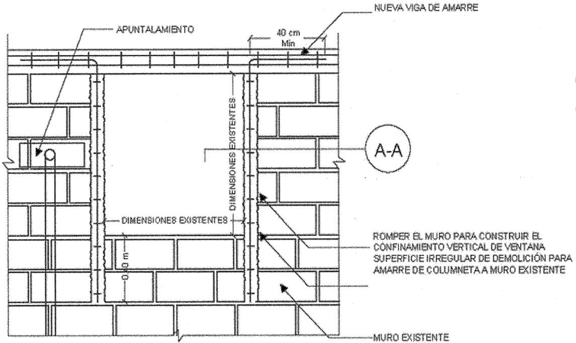
Figura A.3 -15 Dilatación de muros existentes.
