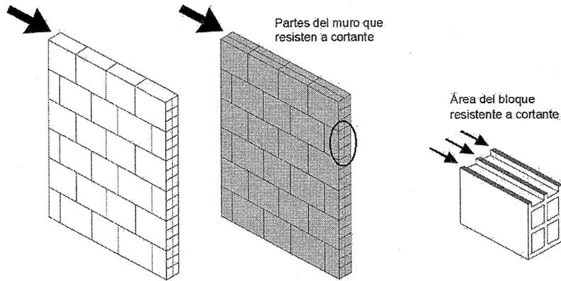
Figura 5-2 Área del bloque resistente a cortante
