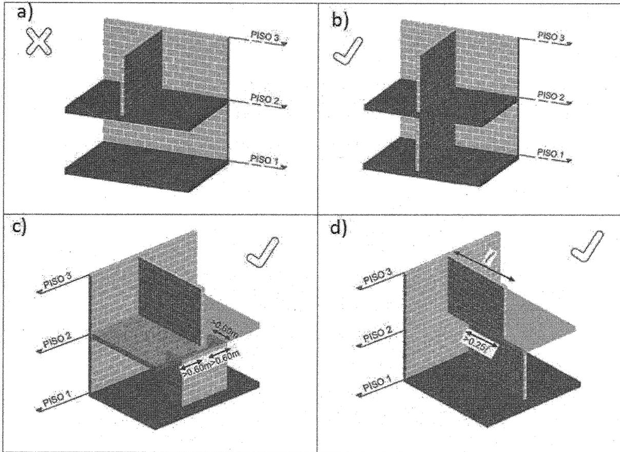
Figura 6.4.3-2 Criterios de continuidad vertical de muros.
