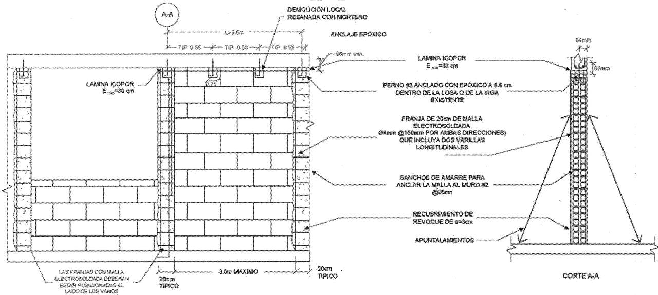
Figura A.3-16 Refuerzo de muro existente con de revoque con malla.
