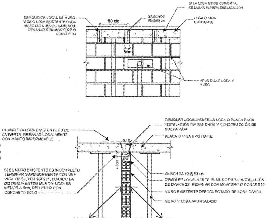
Figura A.3 -18 Conexión de muro nuevo a losa existente con nervios. Muro perpendicular a los nervios.
