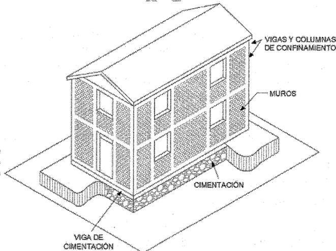
Figura 7.2-1 Elementos estructurales de una vivienda confinada
