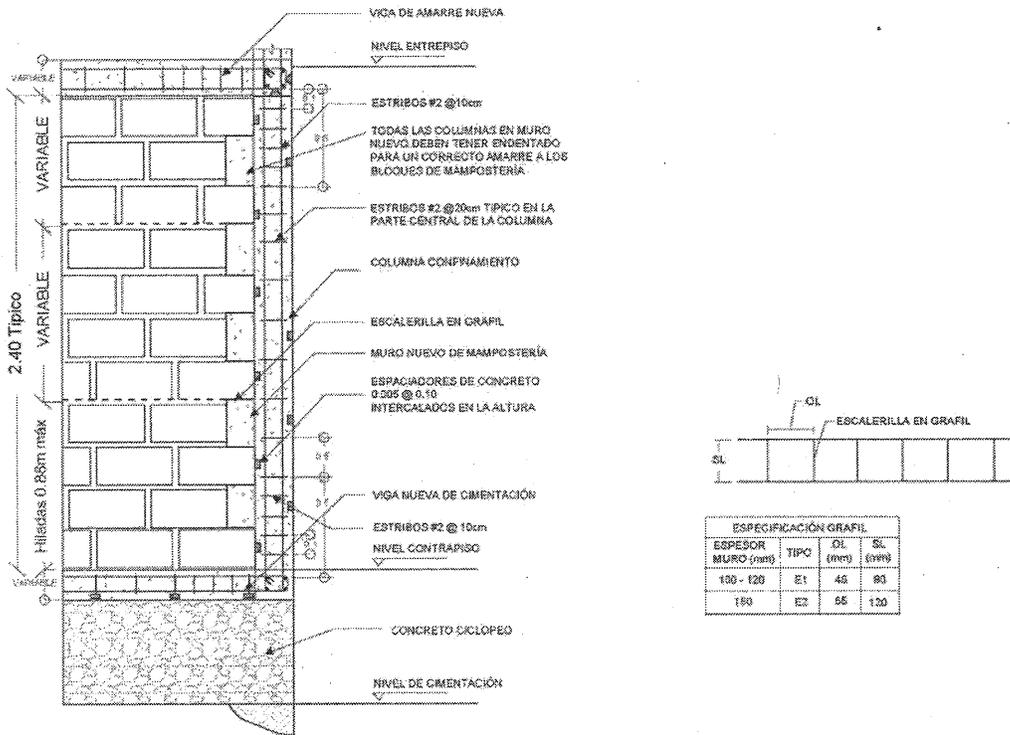
Figura A.3 -11 Esquema de distribución de estribos
