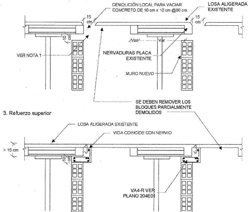
**Refuerzo de sistema de losa con bloquelón y perfiles metálicos existente**
