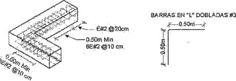
Figura A.3 -14 Refuerzo de vanos existentes.
