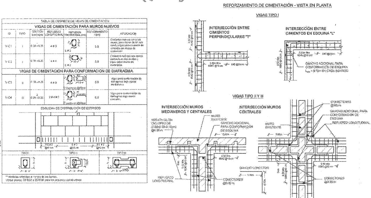
Figura A.3 -7 Nueva viga de cimentación en concreto reforzado para muros perimetrales sobre concreto ciclópeo existente.
