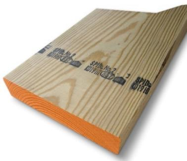
*Figura 1. Madera de pino amarillo del sur con sello de grado estructural*
